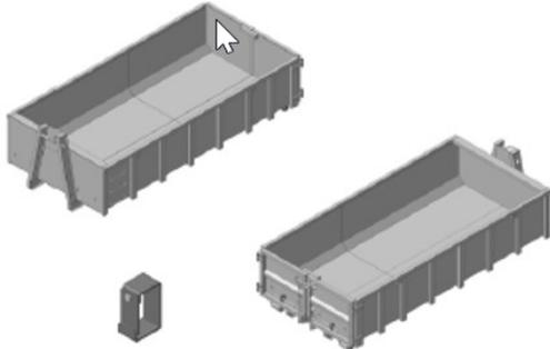
**Benne TP 15 m³ 5500 x 2300 x 1200 mm**
